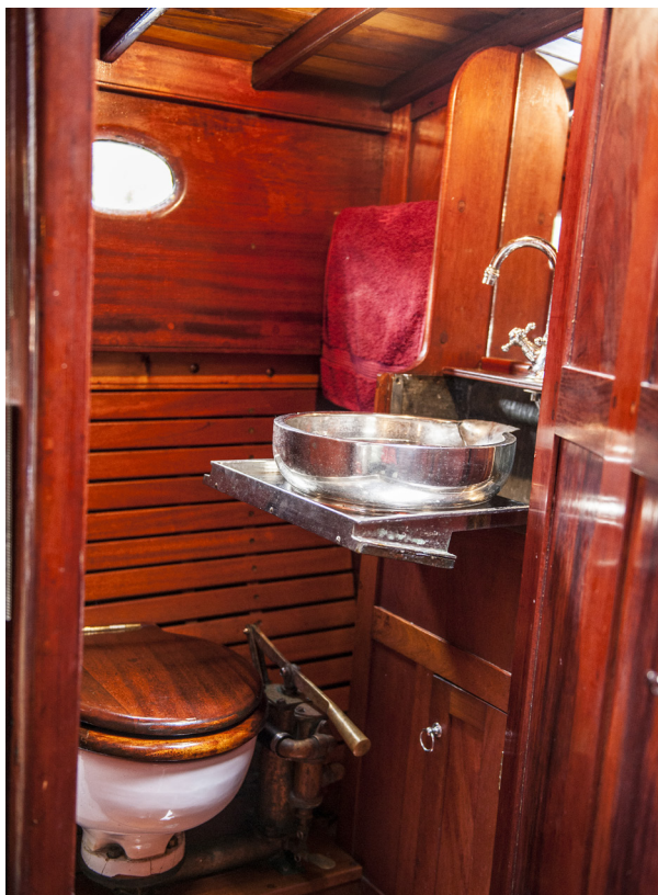
▲ Toaletten med det genialiska, utfällbara handfatet. Det kommer från SJ:s förstaklasskupéer – en lösning som Knut Ljungberg snodde rakt av.
